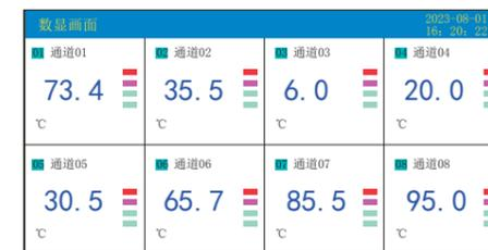
数显画面：显示实时测量值，同时还可显示通道位号、工程单位及报警状态等信息
