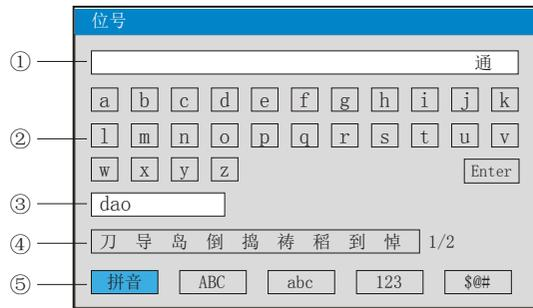
①：输入显示栏：显示输入字符
