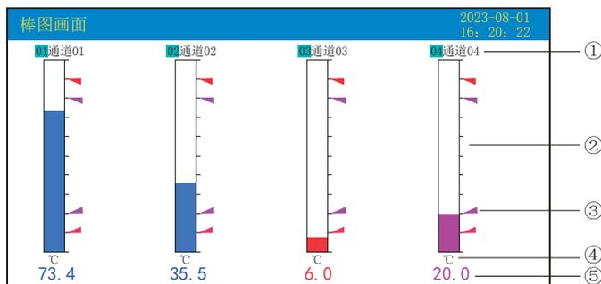
①：通道名称：表示显示通道对应的工程位号，带字库编辑。（关于设置方法请参见“5.12.5.1通道位号输入法”一节）
