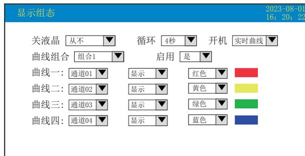
★关液晶：关闭液晶显示，显示屏进入黑屏休眠状态，待下次操作重新点亮显示，可选择5分钟后、10分钟后、30分钟后、1小时后、从不关闭。
