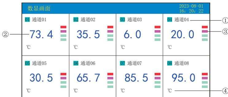
①：通道名称：表示显示通道对应的工程位号，带字库编辑。（关于设置方法请参见“5.12.5.1通道位号输入法”一节）
