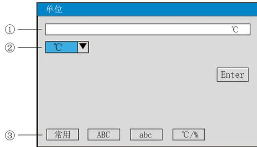
①：输入显示栏：显示输入单位符号
