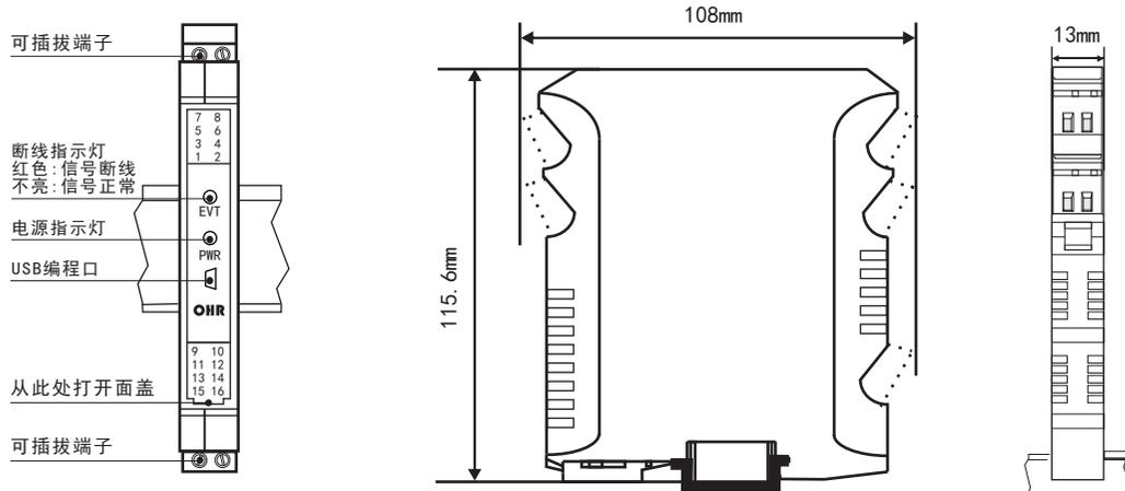
EVT: 断线指示灯，信号存在断线、超上限、超下限时，指示灯红色；信号正常时灯不亮。PWR: 电源指示灯为绿色。35mm导轨式安装，安装时请注意卡位稳定、牢固，请尽可能垂直安装，以利于仪表内部热量散发。
