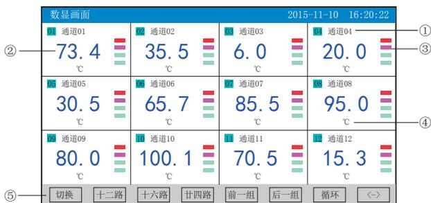
①：通道名称：表示显示通道对应的工程位号，可在通道组态中进行位号设置
