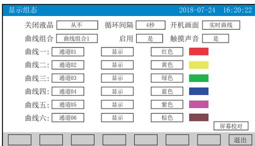
★关闭液晶：降低液晶屏的背光亮度，可选择5分钟后、10分钟后、30分钟后、1小时后、从不关闭
