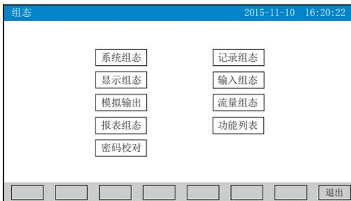
进入组态首先要进行密码校对，点击“密码校对”将出现一对话框，在对话框输入密码（对话框操作可参见第31页“六、T6输入法”一节）。密码由6位数据组成，出厂默认密码为000000，用户可以在“系统组态”——“用户密码”一栏修改校对密码。若密码输入错误，用户将不能进入各组态画面。
