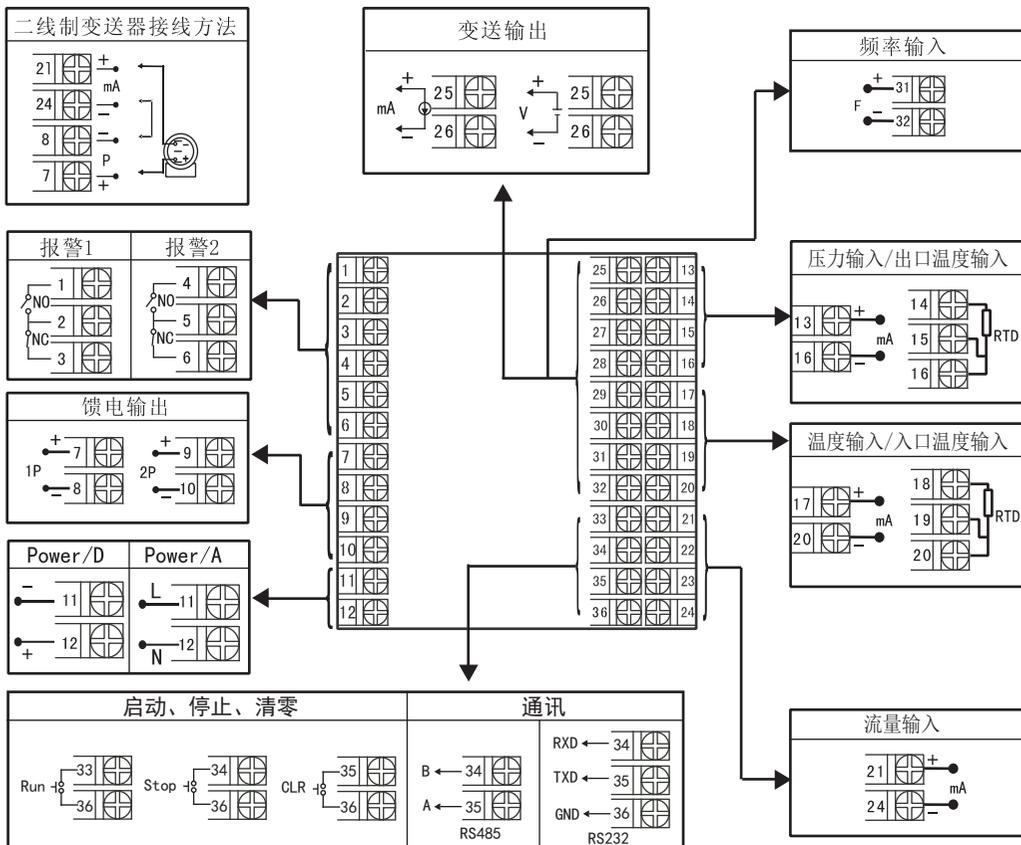
备注：接线图中在同一组端子标有不同功能的，只能选择其中一种功能如RS485和RS232在同一组接线端子上，只能选择一种。
