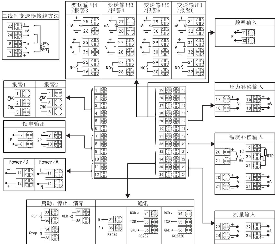
注1：接线图中在同一组端子标有不同功能的，只能选择其中一种功能。如RS485和RS232在同一组接线端子上，只能选择一种。
