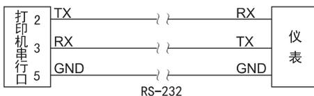
注：仪表与打印机的波特率必须相同（设定仪表波特率请参见仪表二级参数的设定，设定打印机波特率请参见打印机说明书）。
